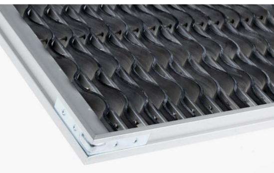
Les profilés spécialement découpés sont fournis sur mesure. Le cadre est facile à assembler. Les profilés sont assemblés à l'aide de coins appropriés. Les ancrages sont insérés dans les rainures extérieures. Les cadres de montage sont disponibles en aluminium ou en laiton.
